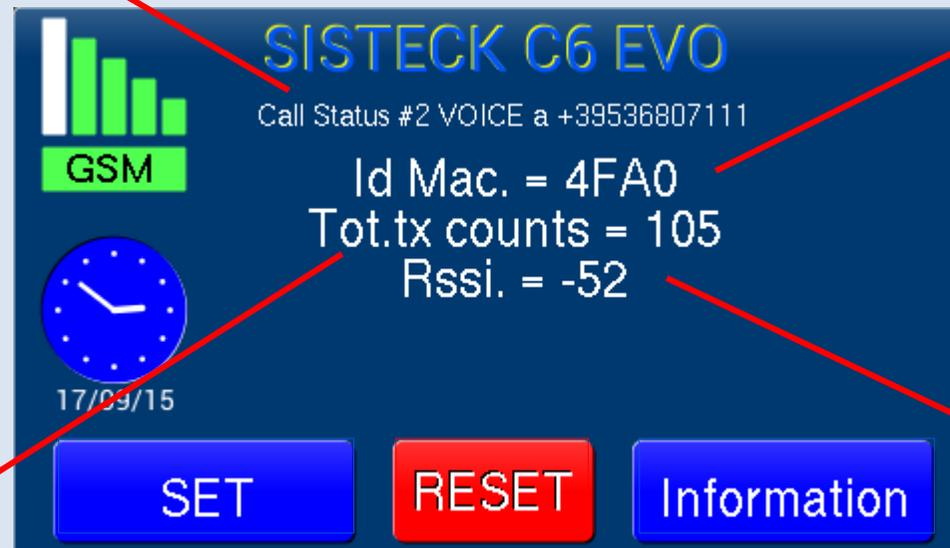
Il contatore trasmissioni totale , che indica il numero di trasmissioni fatte da quel C6 EVO TX
