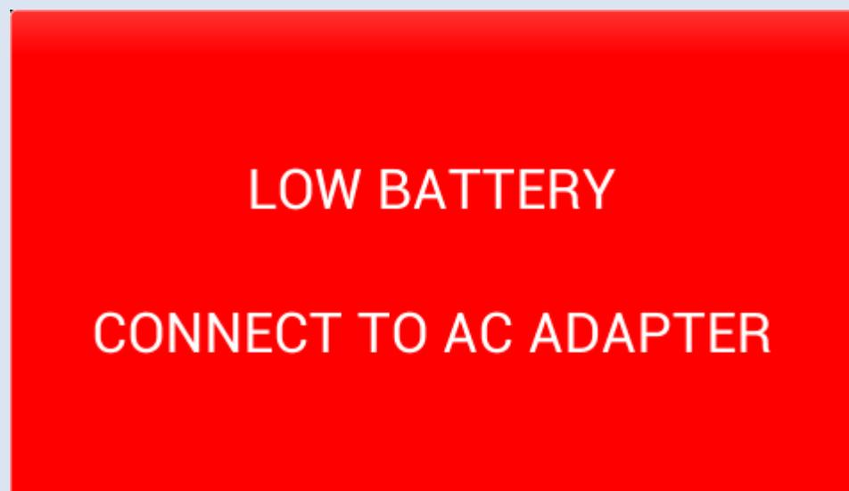
Allarme che segnala basso livello della batteria tampone interna, insufficiente per far funzionare correttamente l'intero sistema.
