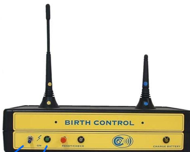
L'interruttore di on- collegato al led verde che appena acceso e con SIM inserita s'illumina in maniera fissa, dopo un attesa di solito inferiore al minuto ed in presenza di segnale di rete GSM la luce verde inizia ad essere intermittente lenta, rimanendo tale fino al momento dell'attivazione allarme dove l'intermittenza si fa più veloce.
