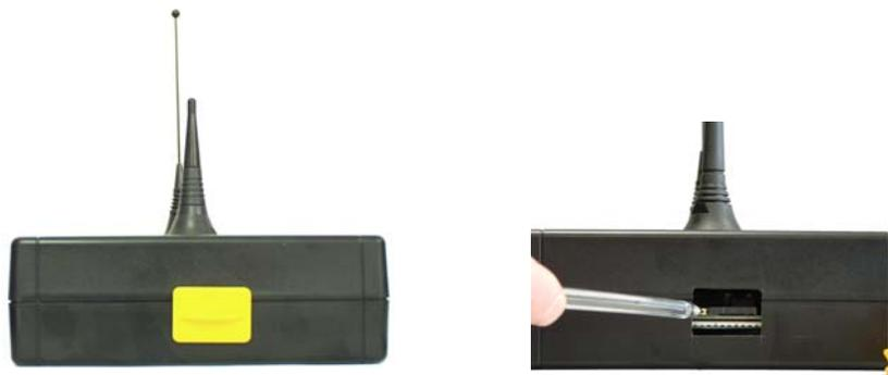
Nella sezione laterale è presente un tappo giallo che copre la fessura di accesso alla SIM card del combinatore telefonico che una volta estratto consente di arrivare al cassetto della SIM.
