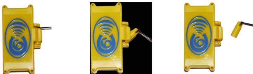
Il modulo C6 B.C. è composto da un guscio in plastica a tenuta stagna contenente un circuito elettronico alimentato a batteria capace di trasmettere onde radio quando sollecitato .
