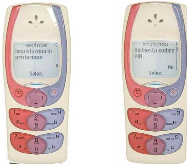
Prima di utilizzare il sistema occorre inizializzare la SIM, che si inserirà poi nell'alloggiamento visto a pag.7, con le seguenti procedure:
