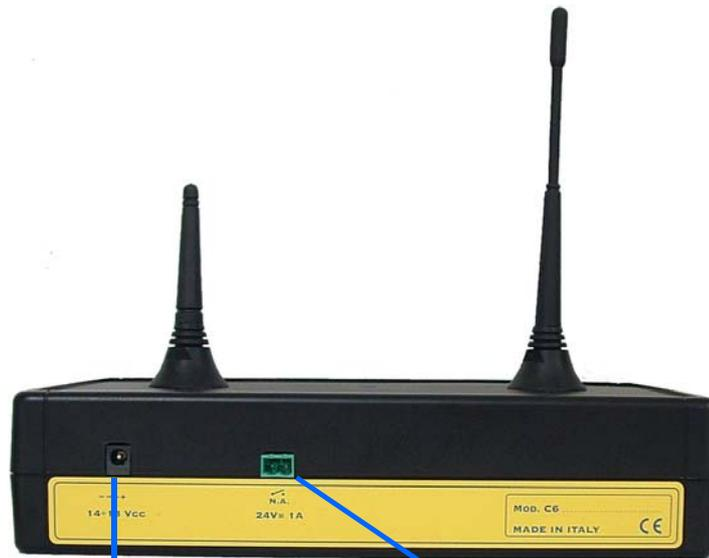
Presa per l'alimentatore a corredo ( 14 - 18 Vcc) con polarità espressamente segnalata.
